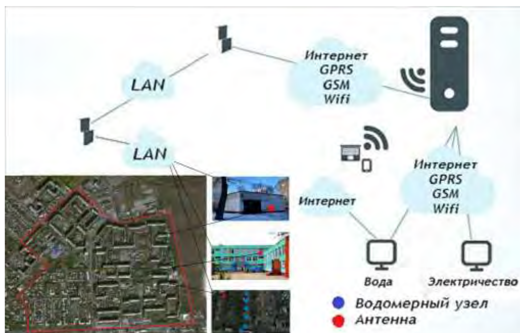
Рисунок 3 - Система контроля и управления водопроводной сетью
