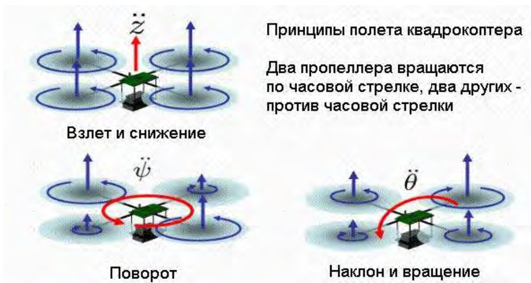
Рисунок 1 – Принцип полета дрона [3]
