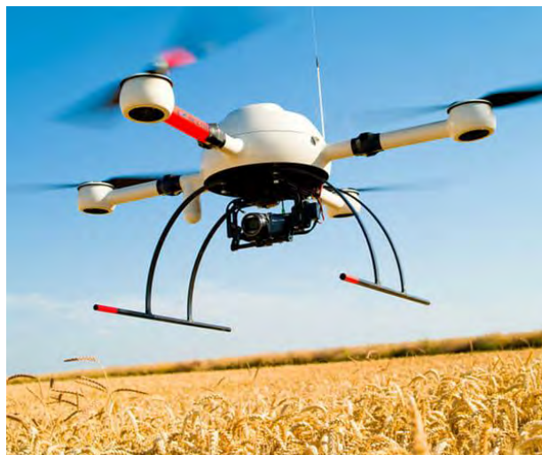
Рисунок 3 – Заменяемый модуль с датчиками и камерой [2]
