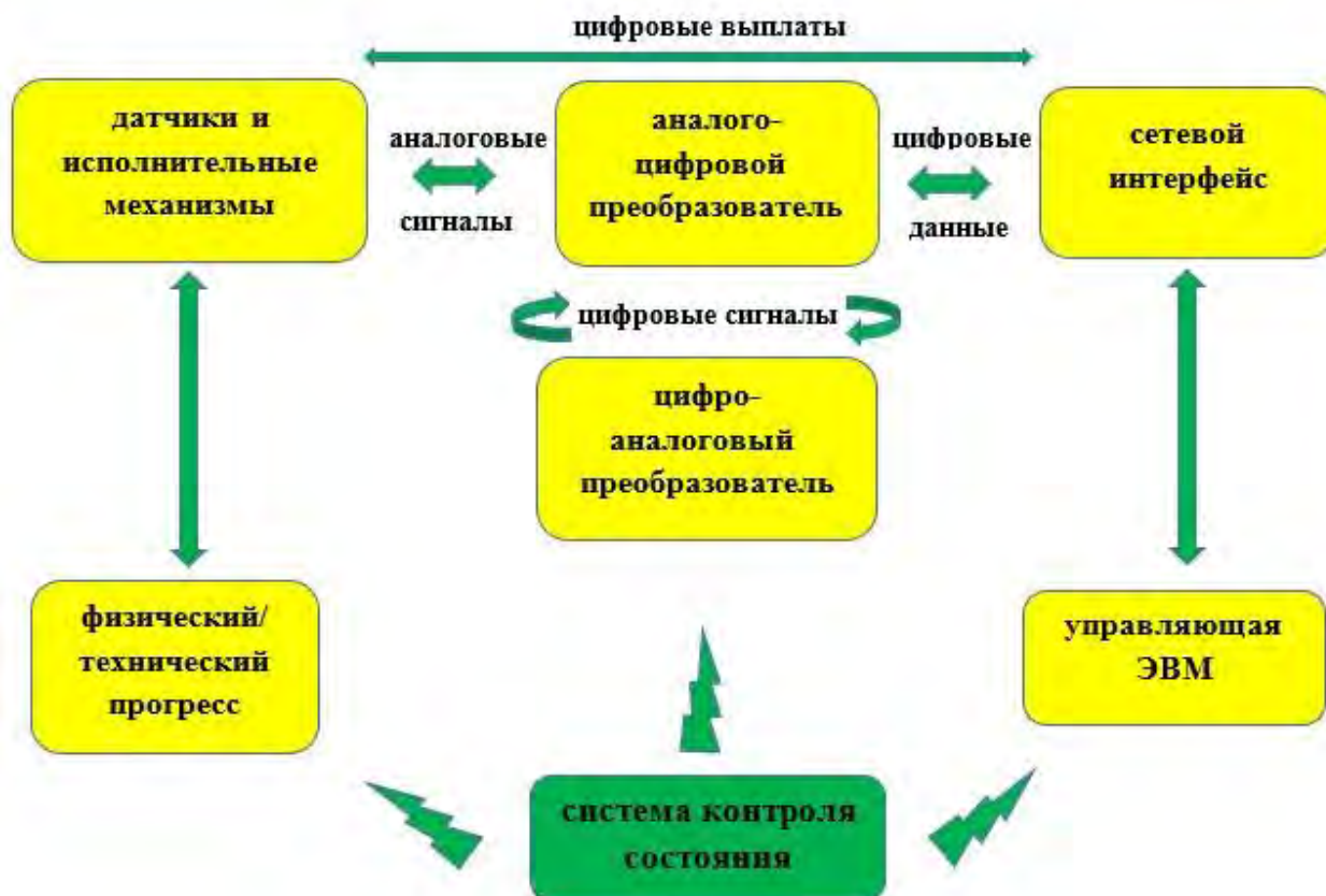
Рисунок 1 - Структурная схема цифровой системы управления
